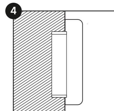
1、墙壁 86 暗盒预留两个大于等于 20mm 的 PVC 管，走气管（气管 10x7mm 及 4x1.5mm 的软绞线，接好线及气管）。把金属支架固定到 86 暗盒，挂上压差测控器即可。
